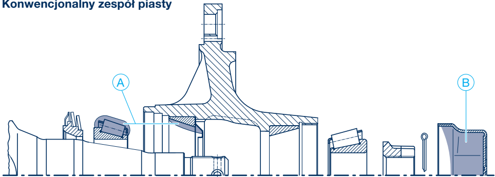
Specjalny smar stały o dużej trwałości BPW ECO-Li Plus / ECO-Li 91 Ilości na jedno łożysko
